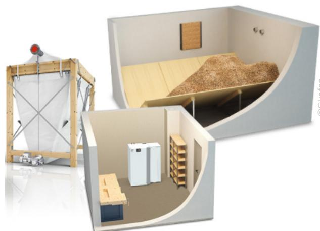
**La pièce de réserve** permet d'avoir un stockage sur-mesure. Cette pièce de réserve est un local aménagé, en maçonnerie ou en panneaux de bois, pour stocker le granulé de bois.
